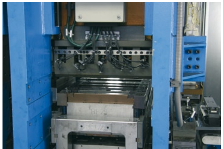
Bei jedem der sieben beziehungsweise neun Werkzeuge eines Schlittens lassen sich fünf Segmente in jeder beliebigen Kombination aktivieren.
