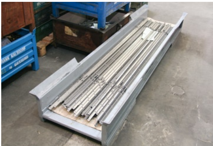
Neben Flachmaterial vom Coil werden auch solche U-Profile gestanzt, die sich auf normalen Stanzmaschinen nicht verarbeiten lassen.
